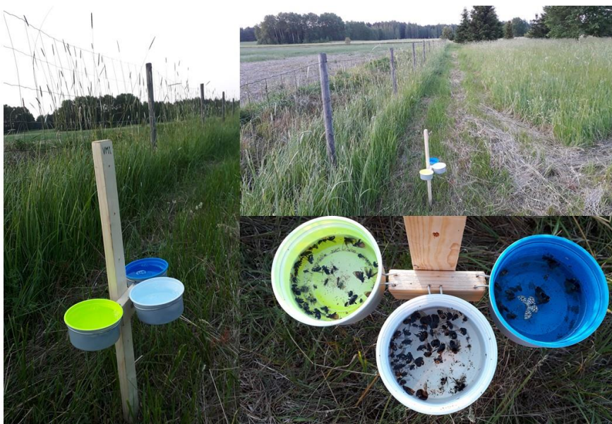
Kuva 4. Potts ym. (2021) suosittelema värimaljapyydys sisältää kolme rinnakkain sijoitettua eri väristä värimaljaa. Kuvan Suomessa kesällä 2021 testikäytössä olleet pyydykset rakennettiin Iso-Britanniassa käytetyn pyydystyyppin rakennusohjeita noudattaen. Suomen seurannassa kullekin seuranta-alueelle esitetään sijoitettavaksi 4 värimaljapyydystä.
