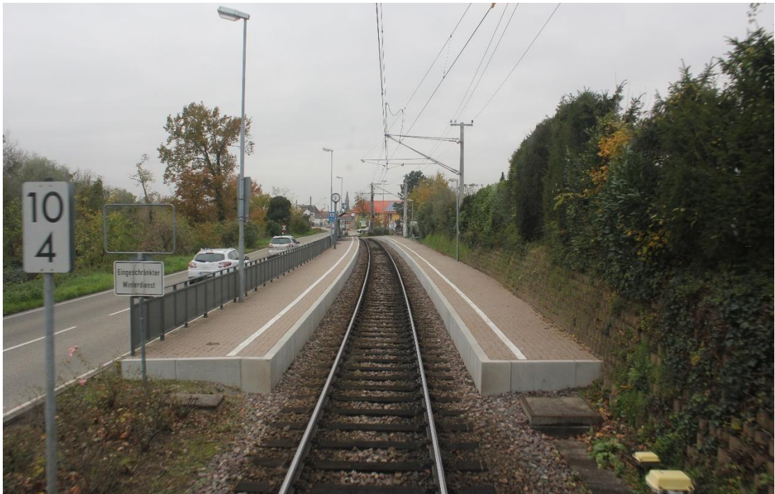
Kuva 14. Linkenheim Südin seisake sijaitsee Saksassa Hardtbahnilla Eggensteinin ja Linkenheimin välisellä rautatieosuudella, jonka henkilöliikenne operoidaan duoraitiovaunuin. Rataosa on osittain yksiraiteinen ja sen liikennöinti perustuu yksisuuntavaunujen käyttöön (ohjaamo vain toisessa päässä ja ovet yhdellä sivulla, raitiovaunut käyttävät kääntösilmukoita pääteasemilla). Tästä syystä seisakelaiturit tarvitaan molemmin puolin rataa. Linkenheim Süd, 21.11.2013. Kuva: Aarne Alameri.
