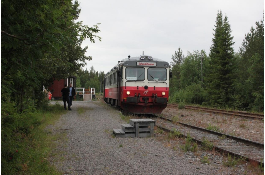
Kuva 20. Moskoselelin asema Ruotsissa Inlandsbanalla Arvidsjaurin ja Gällivaren välisellä rataosalla. Rataosan henkilöliikenteessä on pitkään käytetty Y1-sarjan moottorivaunuja. Liikennöinti perustuu yhden tai kahden moottorivaunun käyttöön. Moskoselelin asemalla yksivaunuinen juna mahtuu laituriin, mutta kahden vaunun tilanteessa neljästä ovesta vain kolme mahtuu laituriin. Tästä syystä asemalla on erillinen porrasaskelma, johonka kohdalle junan neljäs ovi pysäytetään kahdella moottorivaunulla ajettaessa. Moskosele, 11.7.2019. Kuva: Aarne Alameri.
