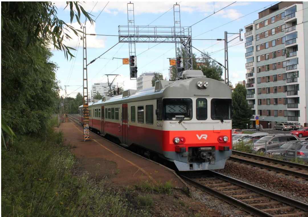
Kuva 9. Amurin korotettu ja asfaltoitu 60 m pituinen betonireunainen seisakelaituri. Seisake on parannettu tilausliikennettä varten, mutta lakkautettu vuonna 2005. Tämän vuoksi sitä ei voi avata uudelleen liikenteelle nykyisten määräyksien mukaan. Ilman hallinnollista lakkautusta seisake olisi voitu palauttaa käyttöön M-junaliikenteen alkaessa Nokialle 16.12.2019. Tällä hetkellä M-junat ohittavat pysähtymättä valmiin laiturin. Laituri olisi mahdollista paaluttaa käyttöön hakemalla poikkeuslupaa sekä toteuttamalla vaadittu palveluvarustus sekä merkinnät. Tämän hetken liikenteen laajuus sekä raiteistonkäyttö mahdollistaisi kaikkien M-junavuorojen ajamisen laituriraiteen kautta, joten tässä tapauksessa kaksiraiteisella radalla riittäisi pelkkä nykyinen laiturin. Amuri, 15.7.2020. Kuva: Aarne Alameri.
