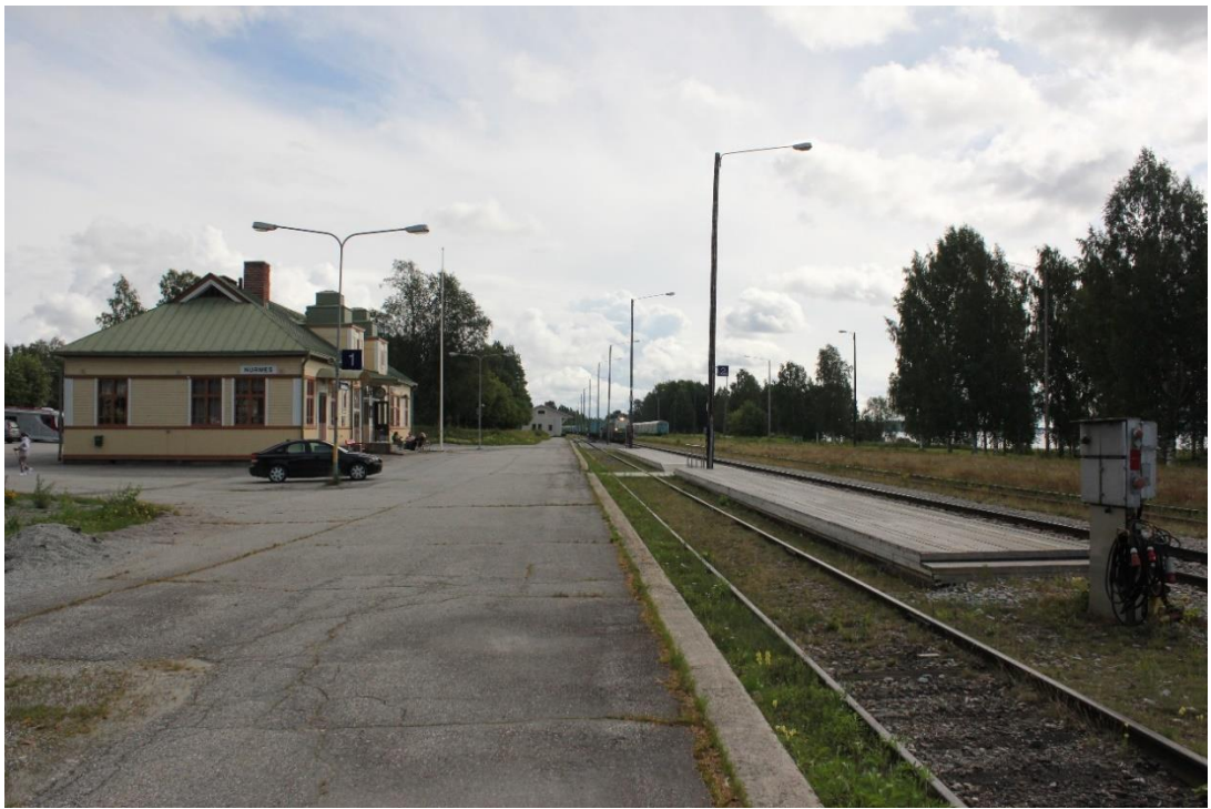
Kuva 5. Nurmeksen ratapihalla on tavanomaisena liikennöintikäytäntönä, että matkustajajunat käyttävät ainoastaan raidetta 2. Tällä on puurakenteinen välilaituri, joka on uusittu mm. kansilankutuksen ja kulkuyhteyden osalta esteettömäksi. Välilaiturin pituus on 71 m. Nurmes, 5.8.2020. Kuvat: Arne Alameri.
