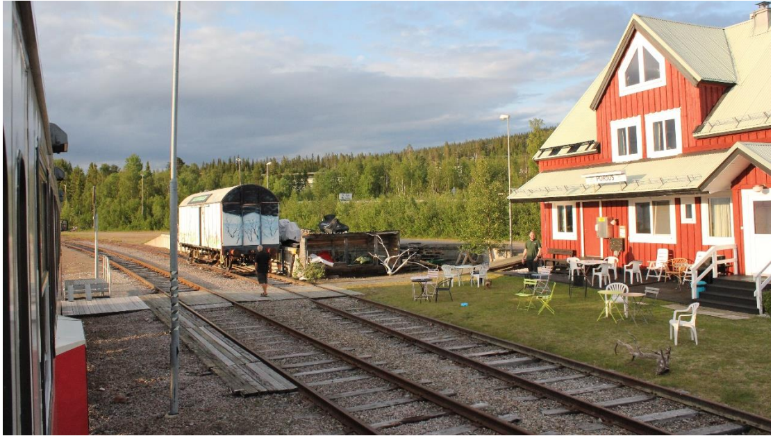
Kuva 24. Porjuksen asema on Ruotsissa Inlandsbanalla Arvidsjaurin ja Gällivaren välisellä rataosalla. Liikennepaikan pääraide sijaitsee kauimpana asemasta, joten laiturin sijoitettu ratapihalle raiteiden väliin ja asemalta laiturille johtaa laituripolku. Laituri on suunniteltu yhden oven mittaiseksi ollen vain noin kahden metrin mittainen. Ritiärakenteiselle laiturille on portaat sekä lastenvaunuramppi. Moottorivaunun etupää on juuri pysähtymässä laiturin kohdalle. Porjus, 11.7.2019. Kuva: Aarne Alameri.
