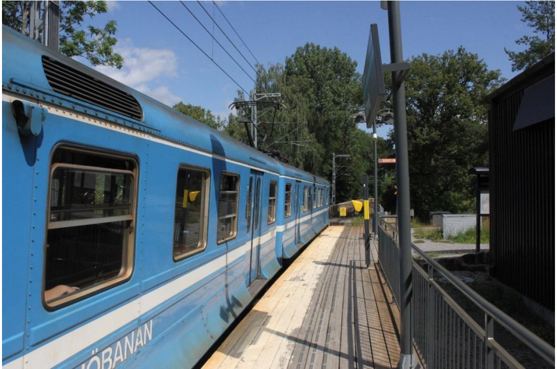
Kuva 3. Östervikin seisake Saltsjöbanan paikallisrautatiellä. Puulaiturin pintaan on erikseen lisätty näkövammaisten liikkumista helpottavat metalliset kohomerkinnot sekä laiturin vaara-alueen reunamerkinnot ja kontrastireuna. Saltsjöbanalla käytettävien C10 ja C11-sarjojen junien korinleveys poikkeaa aiemmasta kalustosta, jonka vuoksi vaunujen koriin on toteutettu erillinen levitys. Östervik, 13.7.2019. Kuva: Arne Alameri.
