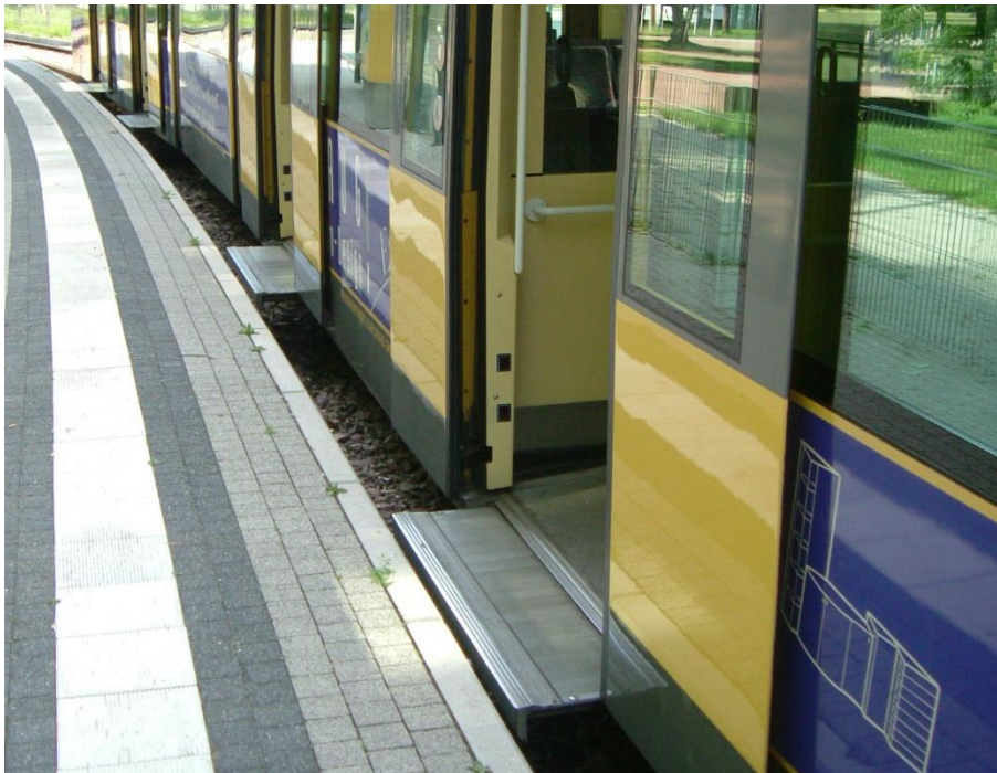
Kuva 13. Duoraitiovaunun kynnyksen ja rautatielaiturin välinen etäisyys täytetään oven kynnyksestä sivuun työntyvällä lipalla. Karlsruhe 30.7.2003 kuva Antero Alku.
