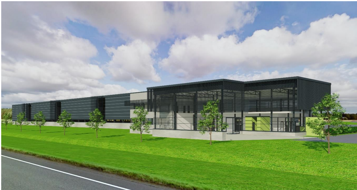
Kuvia korttelin maankäytön alustavasta luonnoksesta. Lähtökohtana on, että rakennusmassa sijoittuu valtatiepuolelle ja huoltopiha rakennuksen taakse. Toimisto-, myymälä- ja asiakastilat muodostavat pääjulkisivun valtatielle päin.
